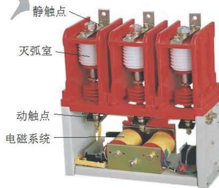
图 8-4 真空接触器结构示意图
